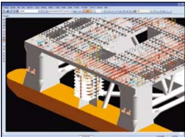
Понтон (трехмерное изображения Scarabeo 8 в AVEVA Marine)
