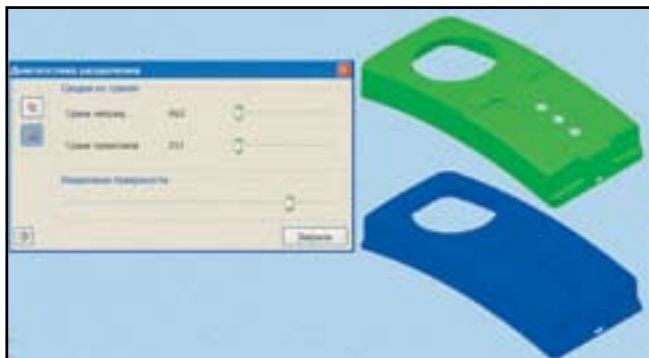
Рис. 4. Результат разделения поверхностей на пуансон и матрицу
