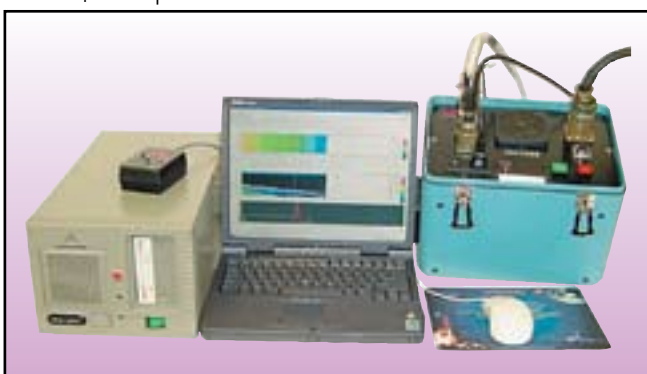
Рис. 3. Портативная переносная установка для автоматического ультразвукового и вихретокового контроля серии IntraSpect/UX
