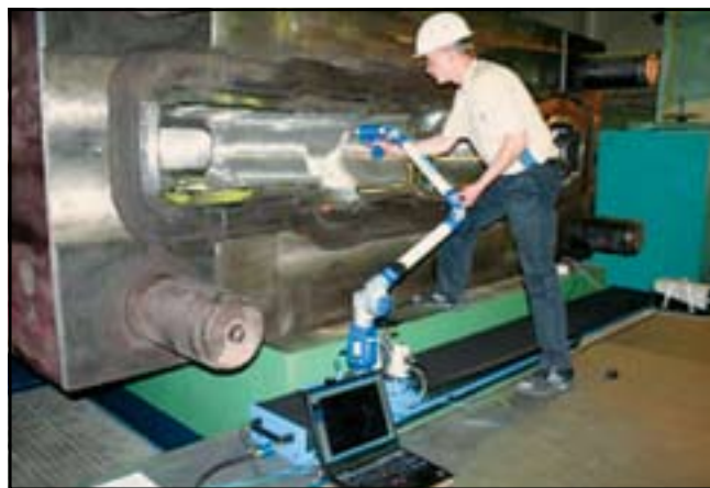
Рис.4. Контроль гравюры длинномерного штампа при помощи КИМ FaroArm P08-05, установленной на прецизионный рельс длиной 3 метра фирмы FARO Technologies
