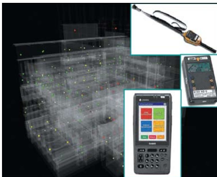
Рис. 6. Пример идентификации объекта с использованием радиочастотных меток
