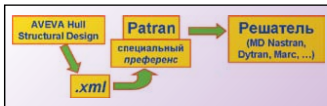
Рис. 1. Импорт геометрической модели из CAD-системы AVEVA Hull Structural Design
