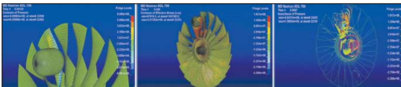
Рис. 8. Напряженно-деформированное состояние и изолинии внутреннего давления (справа) элементов компрессора (второй этап расчета – столкновение с птицей), t=0,001-0,060 сек
