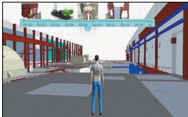
Рис. 3. Виртуальный двойник обучаемого на площадке предприятия. В верхней части рисунка – шкала времени с размещенными на ней стадиями протекания аварии
