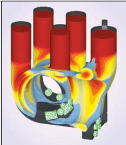
Рис. 3. Кристаллизация сплава в ProCAST с распределением доли твердой фазы
