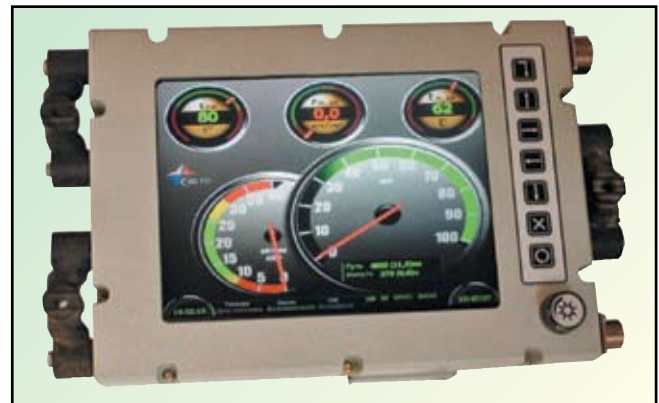
Рис. 7. Фотография информационного блока пульта управления (режим отображения – приборная панель)
