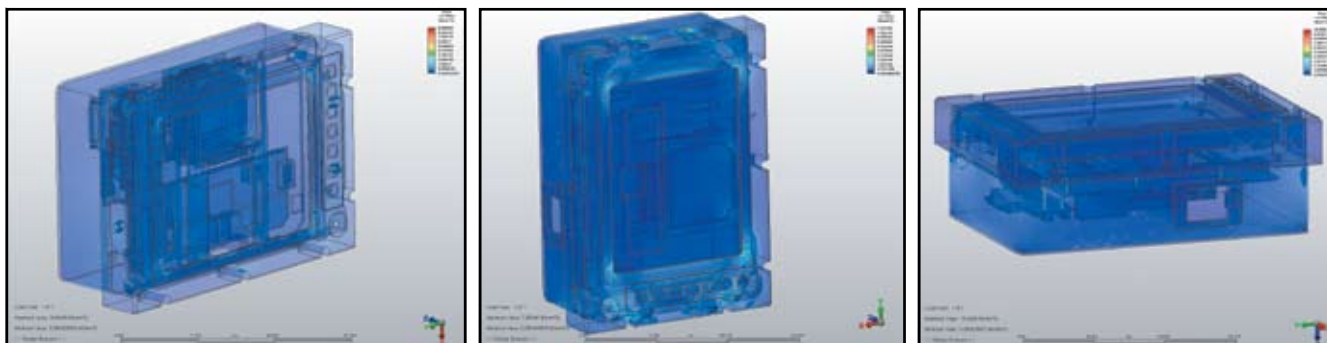
Рис. 3. Результаты моделирования напряжения в конструкции при 10-кратной перегрузке (в направлениях X, Y, Z)
