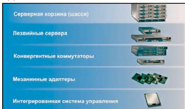
Рис. 3. Компоненты вычислительной системы Cisco UCS
