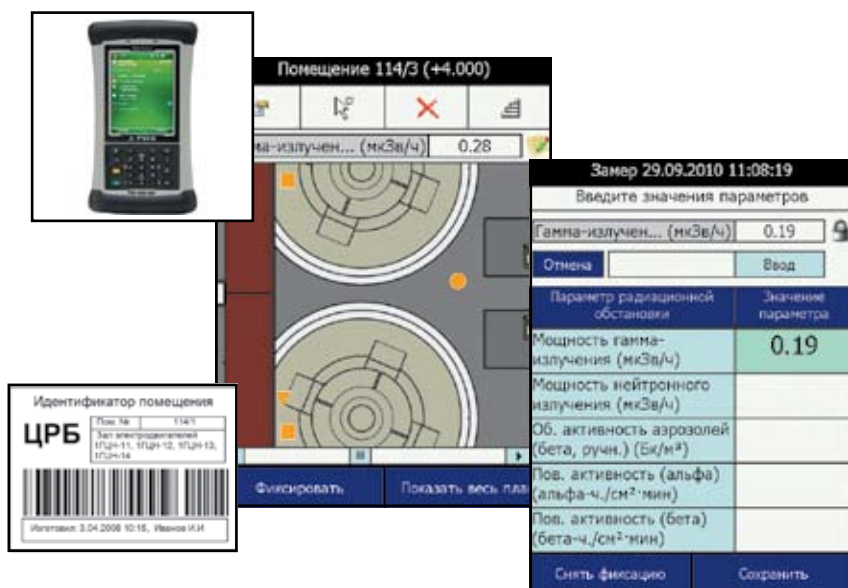
Рис. 5. Применение мобильных терминалов для автоматизированного сбора и отображения данных радиационной обстановки в помещениях энергоблока в АСРМ ЛАЭС
