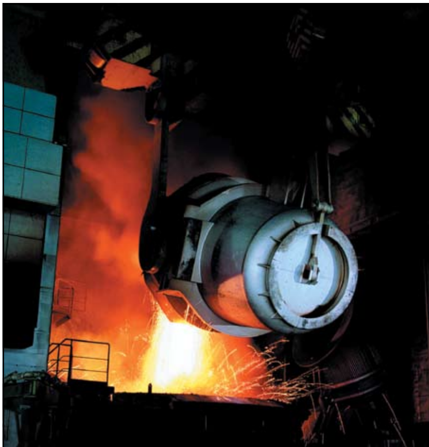
Подача жидкой стали в электропечь
