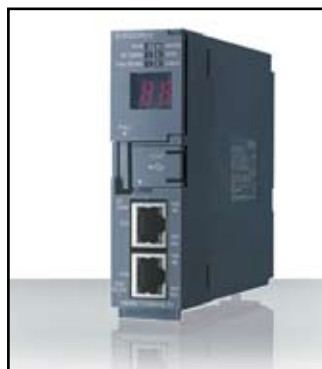
Рис. 1. Новый процессорный модуль Q12DCCPU имеет операционную систему VxWorks и может быть запрограммирован на языках C/C++
