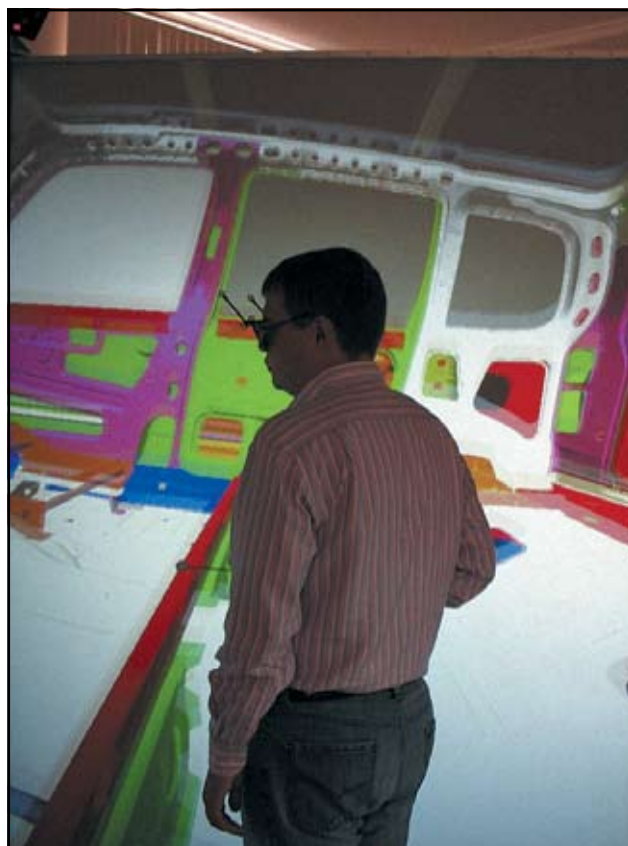
Рис. 3. Визуализация креш-теста автомобиля в системе CAVE 3D в СПбГПУ
