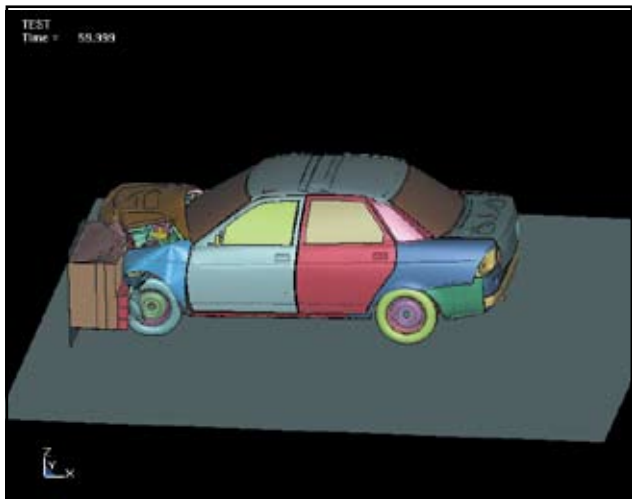
Рис. 2. Моделирование креш-теста на вычислительном кластере
