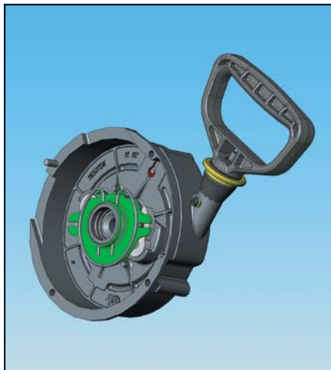
Шкив от ручного стартера снегохода «Буран», спроектированный в среде SolidWorks
