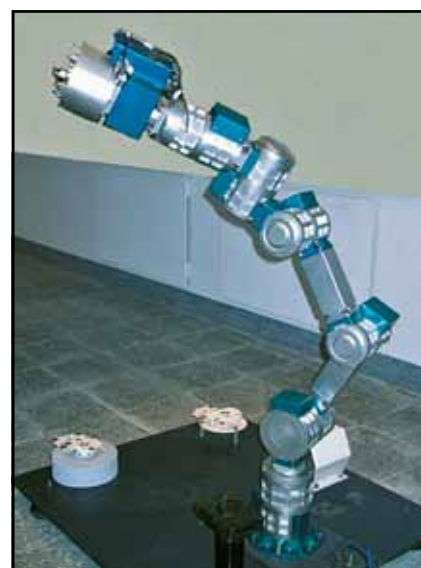
Рис. 2. Космический манипулятор Дорес, разработанный ЦНИИ РТК
