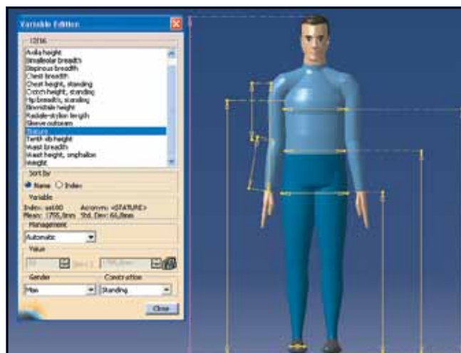
Рис. 2. Инструмент создания манекена в системе DELMIA Human
