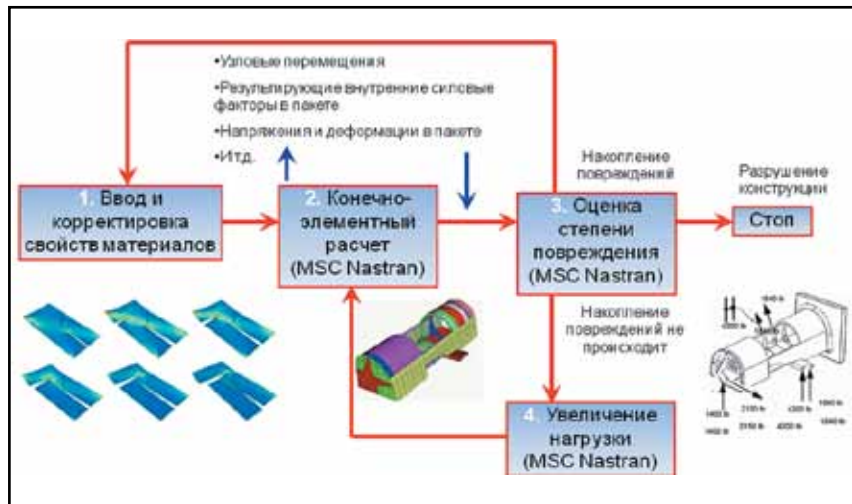
Рис. 4. Алгоритм работы модуля Advanced PFA решателя MSC Nastran
