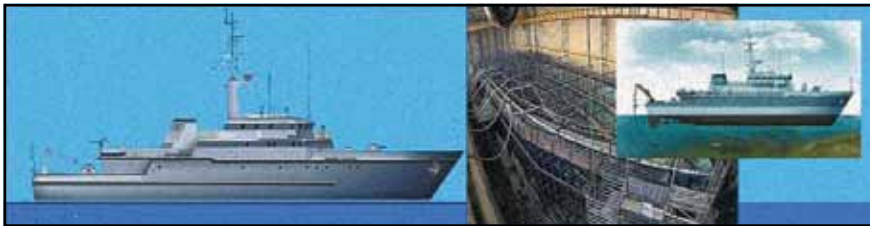
Рис. 6. Корпус корабля, выполненный из композиционного материала
