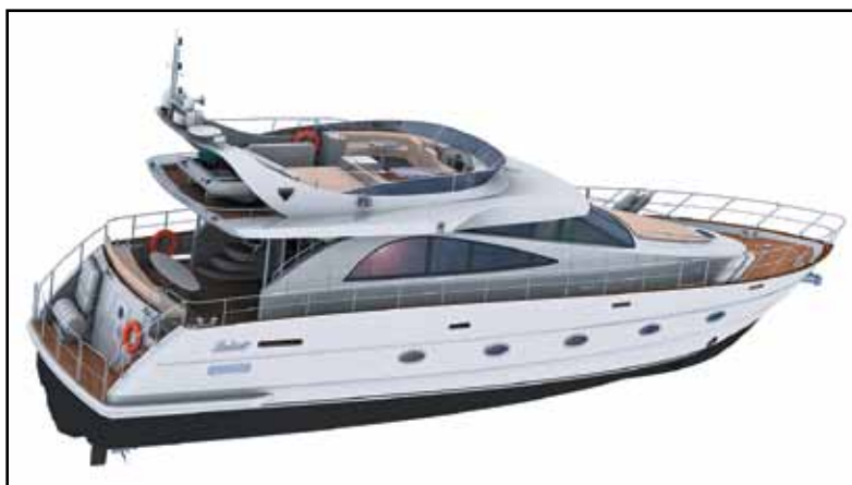
Проект Ls19-M, код "Лотос-19-M" – алюминиевая скоростная моторная яхта, разрабатываемая компанией "Си Тех" в системе Nupac-Cadmatic
