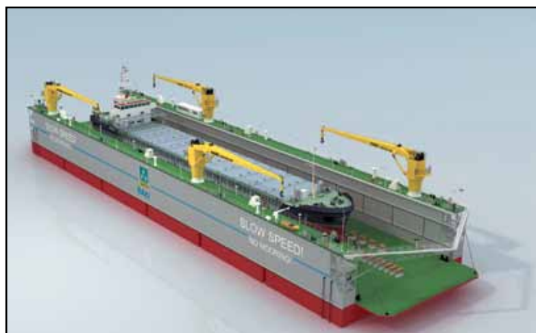
Проект 28140 – плавучий док грузоподъемностью 8000 т, разработан компанией "Си Тех" в системе Nupac-Cadmatic
