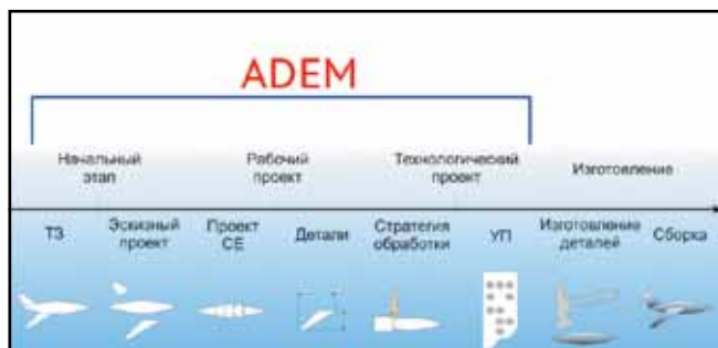
Рис. 1. Место, занимаемое CAD/CAM/CAPP ADEM в производственном процессе
