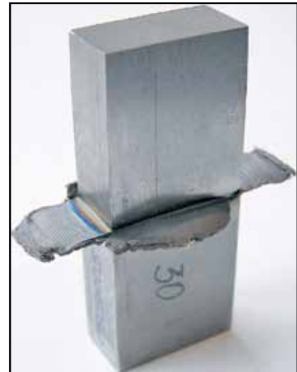
Рис. 2. Образцы, сваренные с помощью ЛСТ
