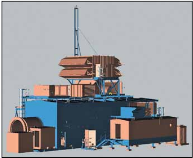
Рис. 3. Модели газовых турбин SGT-800 (Siemens) и котлов-утилизаторов (ОАО “ЭнергоМашиностроительный Альянс”)
