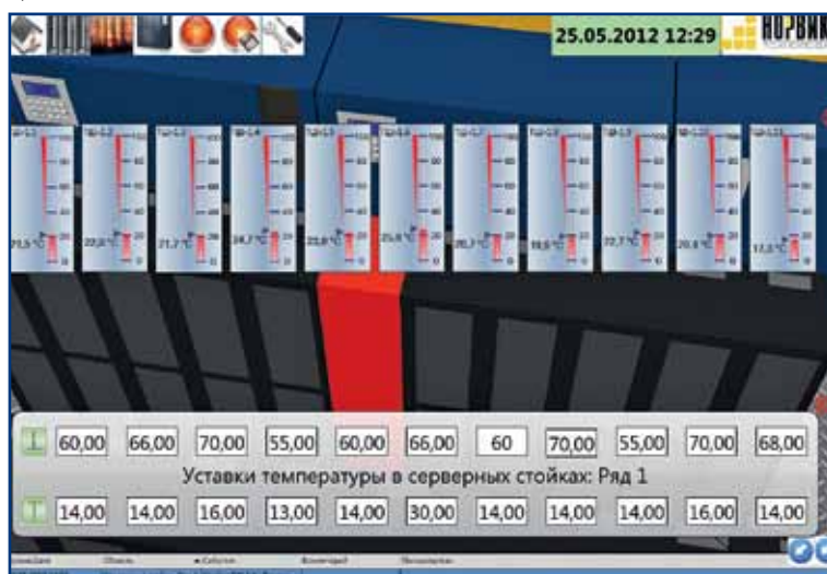
Рис. 3. Пример 3D-реализации АСДУ в случае возникновения нештатной ситуации а – общий 3D-вид центра обработки данных с отображением аварии (повышение температуры в серверной стойке); б – вид после перемещения “камеры” к месту аварии с одновременным отображением текущих значений параметров
