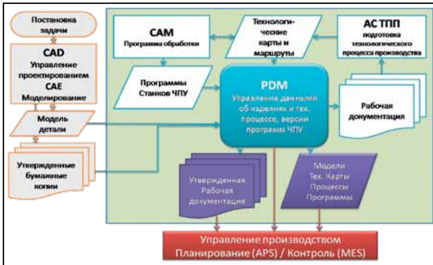
Рис. 3. Укрупненная схема процесса конструкторско-технологической подготовки производства
