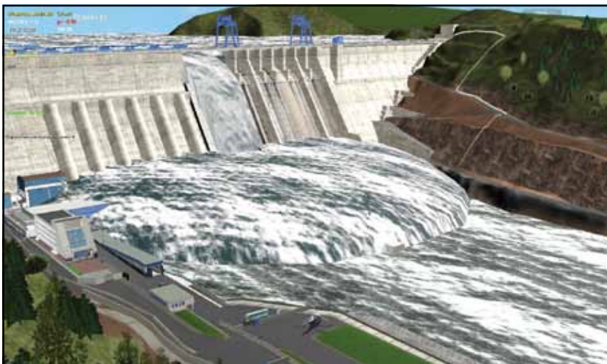
Имитация работы водосброса плотины Бурейской ГЭС в интерактивной модели, выполненной ВНИИГ им. Б. Е. Веденеева (ОАО "РусГидро")
