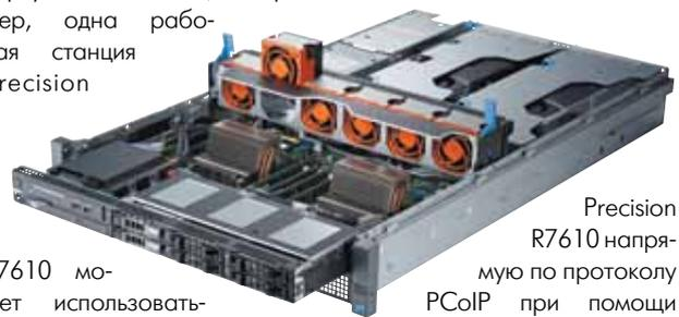
Precision R7610 напрямую по протоколу PCoIP при помощи процессора Teradici Tera с нулевого клиента Dell Wyse P25 или Dell Wyse P45.
