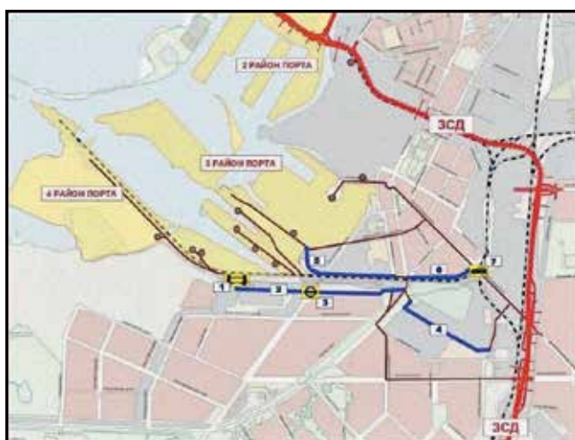
Рис. 4. Подключение терминала к южному участку Западного скоростного диаметра (ЗСД)
