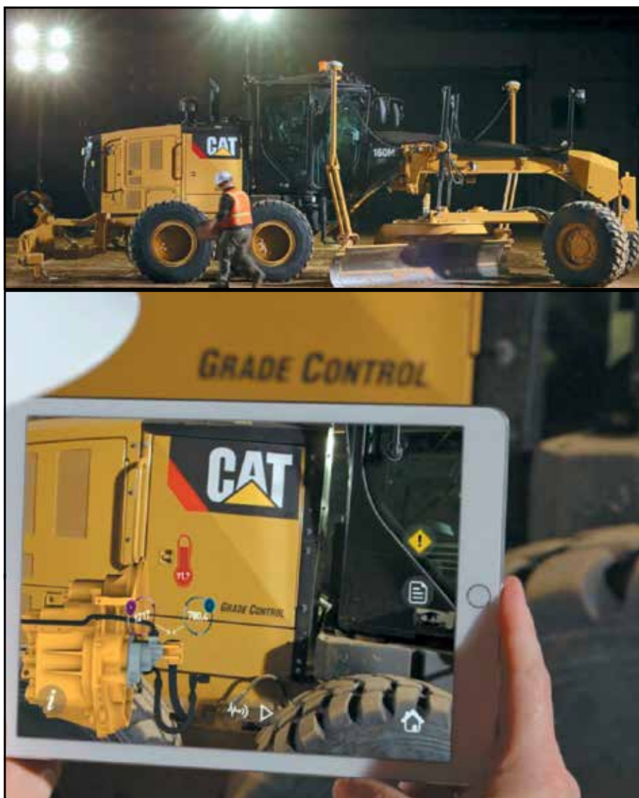
Рис. 12. Применение AR- и DT-технологий (сотрудничество PTC и Caterpillar)
