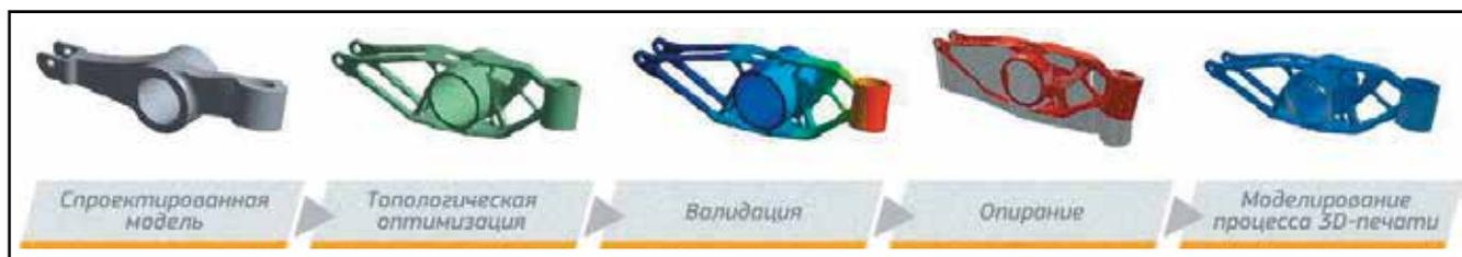
Рис. 1. Этапы моделирования аддитивных технологий в ANSYS
