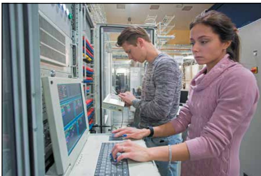
Проверка выходных ARINC-сигналов с помощью анализатора на имитаторе двигателей
