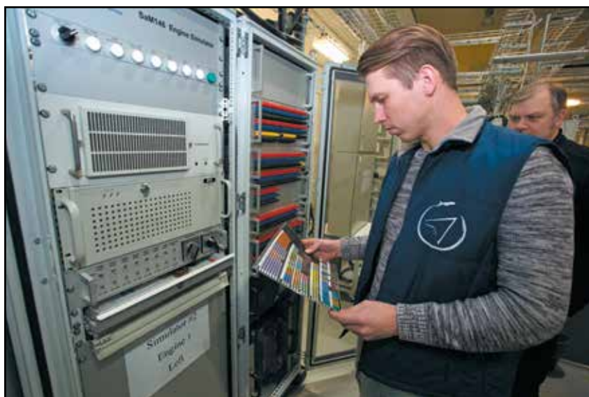
Установка отказов блоков DECU на имитаторе двигателей
