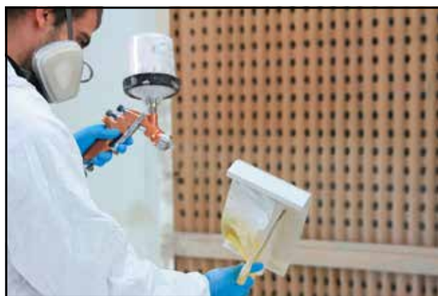
Окраска разделительной панели
