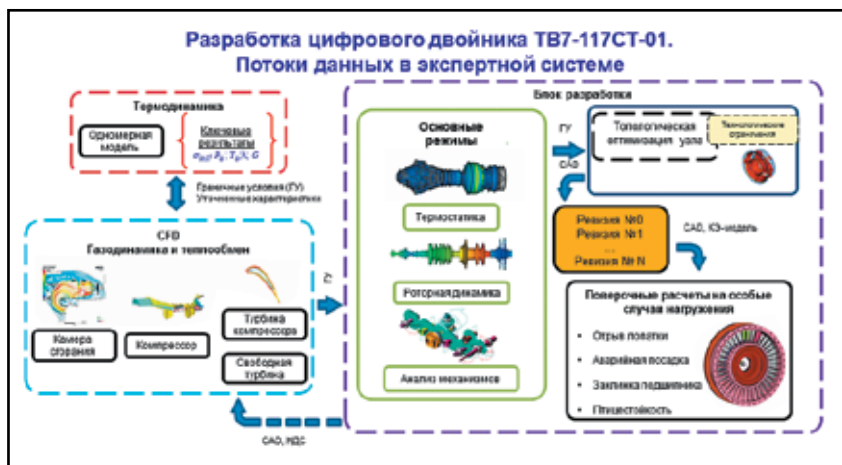
Рис. 6. Схема потоков данных Цифрового двойника двигателя ТВ7-117СТ-01
