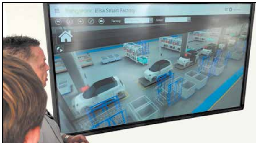
Рис. 3. Цифровой двойник производственной линии на заводе электрокаров e.GO Mobile AG в Германии. На линии более 60 подключенных сборочных постов
