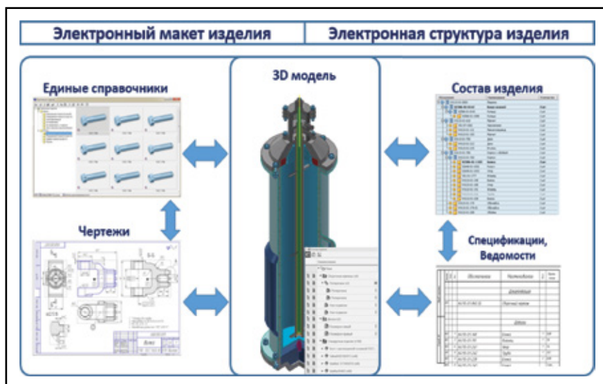
Рис. 5. Создание разработчиком КД электронной структуры изделия, 3D-моделей, электронных документов в PDM/PLM-системе организации
